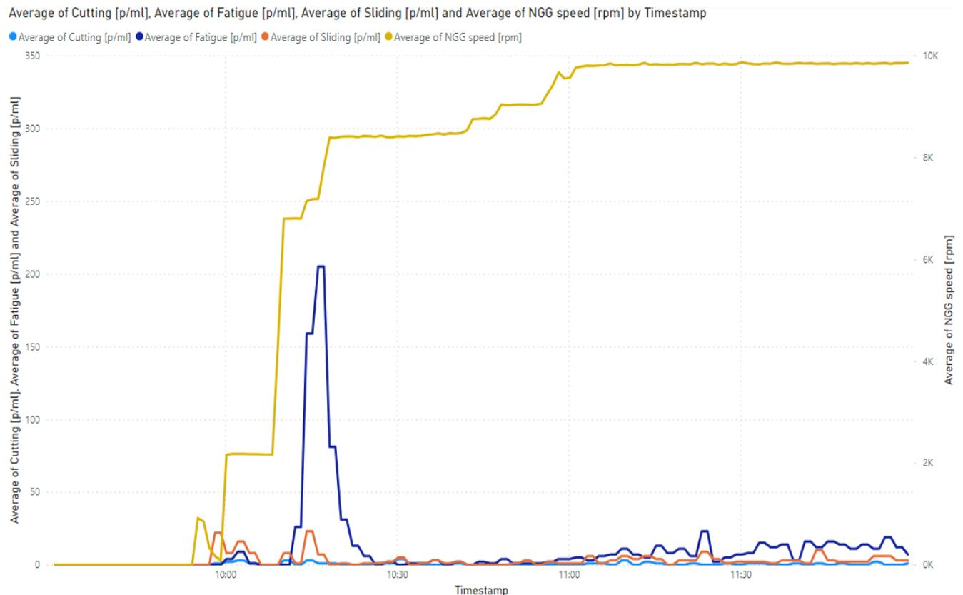
En los gráficos se muestra el incremento en número de partículas y especialmente el modo de desgaste de fatiga que se presentó durante sucesivos arranques en el sistema de lubricación de turbina. El estudio continuado de estos fenómenos permitió al cliente monitorizar la severidad de las paradas y arranques.
